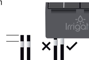
sein (um Auslaufen zu vermeiden) und sollte die Steuereinheit nicht aus der Vertikalen ziehen. Um eine sichere Verbindung zu erhalten und größere Probleme zu vermeiden, schieben Sie 5 mm des Schlauchs in den Schlauchverbindungsanschluss hinein. Messen Sie dazu einfach 5 mm ab und markieren Sie die Stelle mit einem Stück Klebeband.
