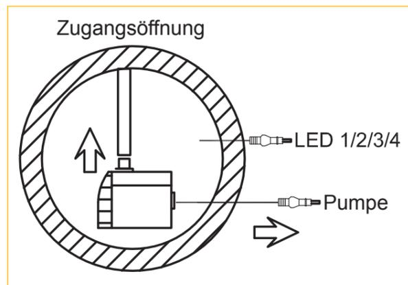
3.2 Verbinden Sie die Pumpe und die LEDs mit dem Netzteil (siehe Abbildung)
