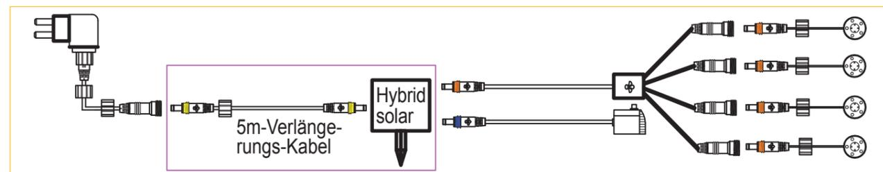
Verbinden Sie Pumpe, LED-Leuchten und Netzteil mit dem Hybrid-Solarpanel. (siehe Abbildung)
